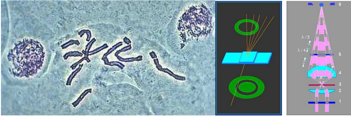
Abbildung 2.1: Links: die mitotische Zellteilung (K. Michel, Carl Zeiss, 1943). Mitte: Anordnung der Ringblende unterhalb des Objektivs und des Phasenrings im Objektiv (Werkfoto: Carl Zeiss). Rechts: Der Strahlengang im Phasenkontrastmikroskop. 1=Ringblende, 2=Kondensator, 3=Präparat, 4=Objektiv, 5=Phasenplatte, 6=Brennebene des Objektivs. Der Wellencharakter des Lichts ist durch die Abfolge heller und dunkler Bereiche angedeutet (Werkfoto: Carl Zeiss).
