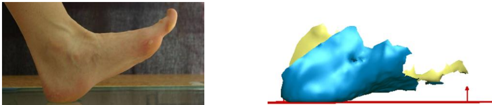
Abbildung 29: Diskrepanz zwischen tatsächlicher und technisch erfassbarer Fußform auf Grund zu hoher Objektgeschwindigkeit am Beispiel des Ersten Fersenkontakts
