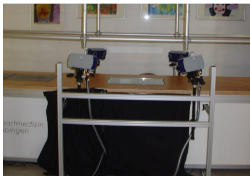
Abbildung 67: Erweiterung des Scannersystems zur Erfassung der gesamten Fußform
