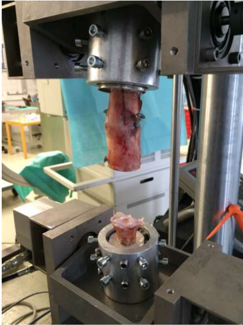
Abbildung 3: Einspannen des Präparats in MTS 858 Mini Bionix II
