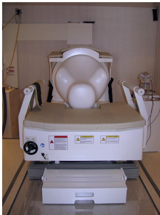
Abbildung 9: Das fMEG-Messgerät in einem magnetisch abgeschirmten Raum in einer eingestellten Position für die Probandinnenmessungen, (Quelle: f-MEG Zentrum der Universitätsfrauenklinik Tübingen, Deutschland)
