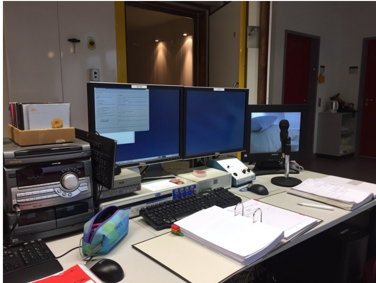
Abbildung 8: Messplatz des fMEG-Zentrums. Von links nach rechts: CD-Player, zwei Bildschirme für Messeinstellungen und Aufzeichnungsüberwachung, ein Kamerabildschirm für die Überwachung der Probandinnen während der Messung, Sprechanlage.
