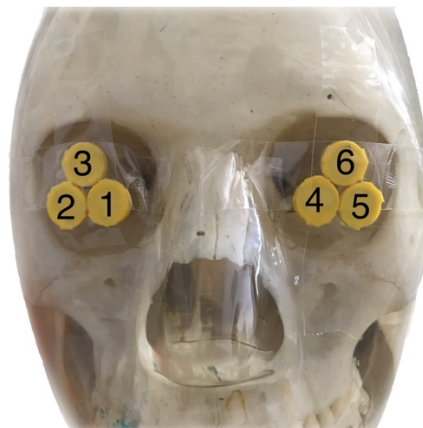
Abbildung 4: Positionierung der TLD-Chips am Röntgenphantom
