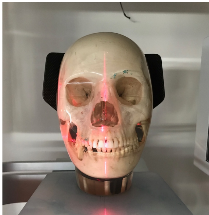
Abbildung 2: Darstellung der Positionierung des Phantomkopfes im KaVo DVT sowie dessen Ausrichtung anhand der Lasermarkierungen.
