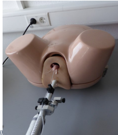
Abbildung 21: Blase im Modell während Druckmessung
