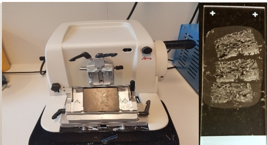
Abbildung 39: Erstellen der Dünnschnitte mittels Mikrotom
