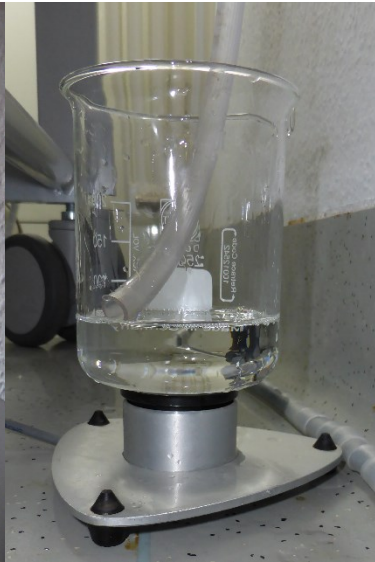
Abbildung 14: Messbecher auf Wage zur Leckagebestimmung
