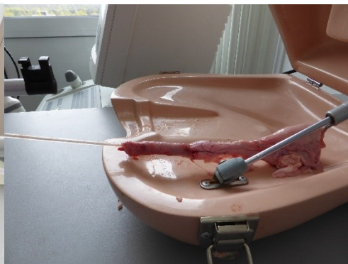
Abbildung 47: Zugvorgang an Schweineblase
