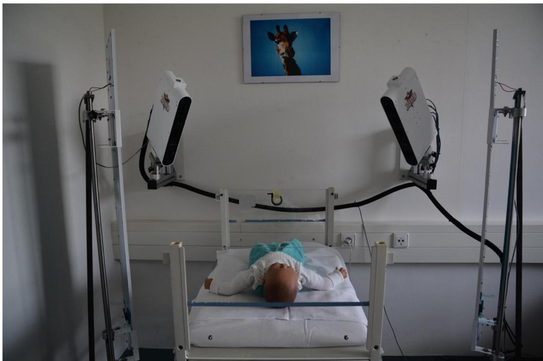
**Abbildung 2** Das 3D-Scannersystem mit einer Puppe als Beispiel für die richtige Positionierung der Probanden während der Bildaufnahme
