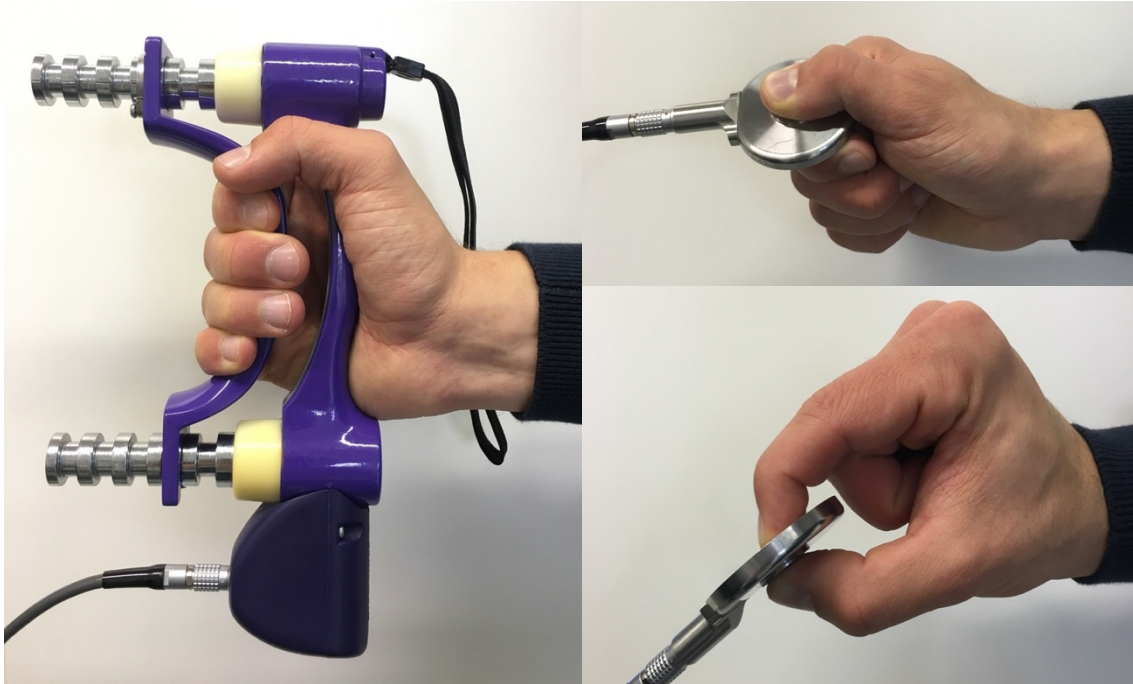
Abbildung 6: Links: Dynamometer G100 und Kraftmessung in der Position „Kraftgriff“. Rechts oben: Pinchmeter P100 und Kraftmessung in der Position „Schlüsselgriff“. Rechts unten: Kraftmessung in der Position „Pinzettengriff“.
