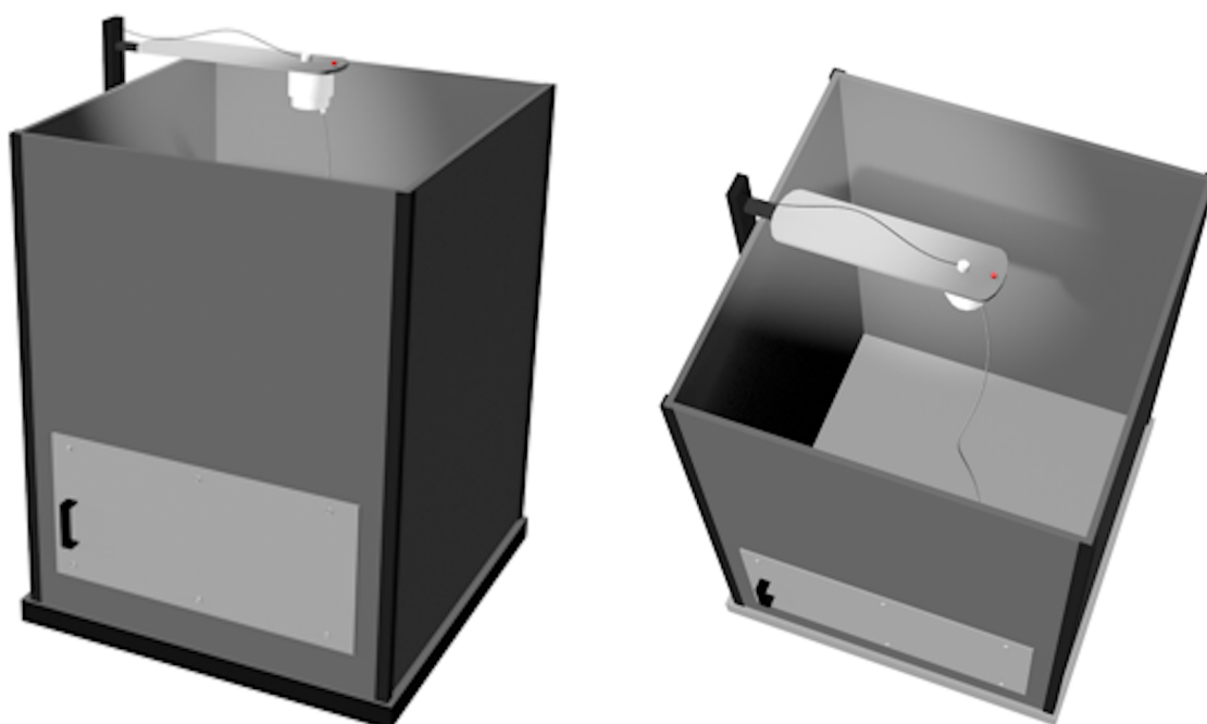
Abbildung 6: Schematische Darstellung der Aufzeichnungsbox von EEG und EMG; links: Seitenansicht, rechts: Aufsicht; erstellt mit Cinema 4D
