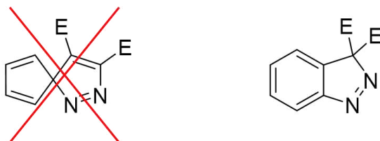
Abbildung 4. Die Vorstufen der Cyclopropabenzole über die spiro-3 H -Pyrazolroute haben in Wahrheit 3 H -Indazolstruktur. 29
