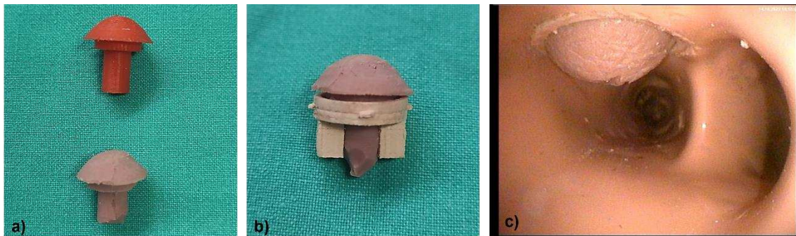
Abbildung 18: Erstellung des Tumor-Patches a) 3D-gedruckte Tumorform (oben), in Silikonknetmasse ausgegossenes Tumor-Patch (unten) b) Tumor-Patch in Adapter 2 integriert c) Tumor-Patch im Wechselmodul aus bronchoskopischer Sicht.
