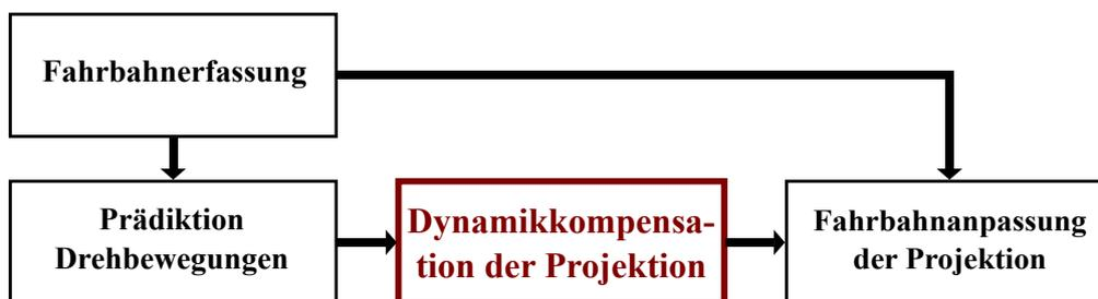
Abbildung 7.8.: Position der Kompensation der Scheinwerferbewegungen (rot) im Gesamtsystem
