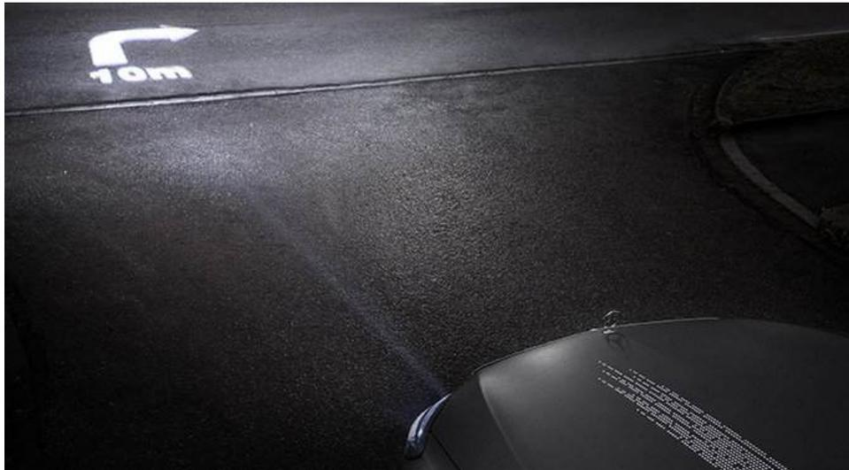
Abbildung 1.1.: Unterstützende Symbolprojektion des Scheinwerfers durch Anzeige eines Navigationspfeils [©Mercedes-Benz AG]
