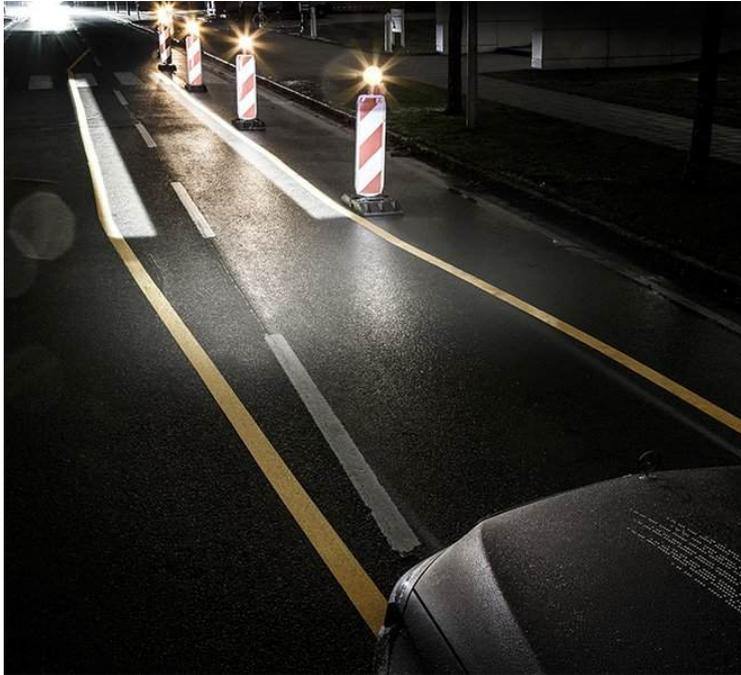
Abbildung 2.3.: Fahrspurprojektion im Baustellen-Szenario [©Mercedes-Benz AG]
