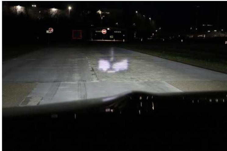
Abbildung 8.12.: Symbolprojektion auf einer stark beschädigten Fahrbahn mit großen Unebenheiten
