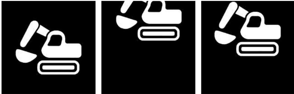
Abbildung 7.5.: Symbolprojektion auf dem Pixelarray für ein Pseudo-Nickaustgleich. (a) Grundzustand, (b) Reale Verschiebung und (c) Begrenzte Verschiebung.
