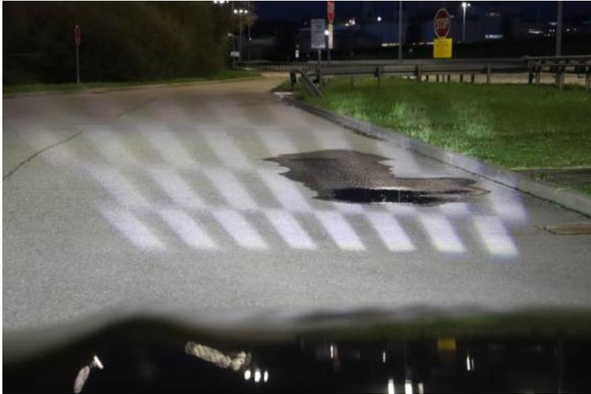
Abbildung 4.2.: Projektion auf nasser Fahrbahn
