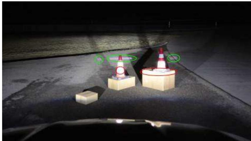
Abbildung 4.30.: Reflexionen an Objekten in Richtung der Kamera aufgrund Abblendlicht des Scheinwerfers
