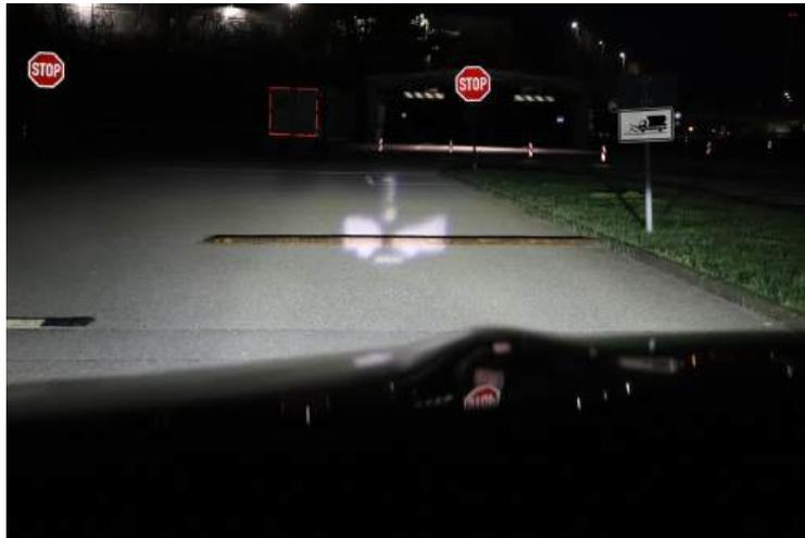
Abbildung 8.13.: Symbolprojektion auf eine Geschwindigkeitsschwelle
