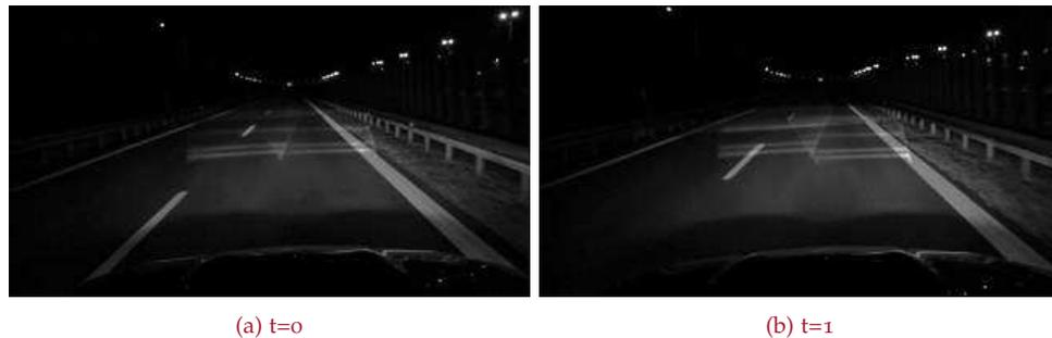
Abbildung 8.5.: Zeitlicher Verlauf der Symbolprojektion bei einem Bremsvorgang
