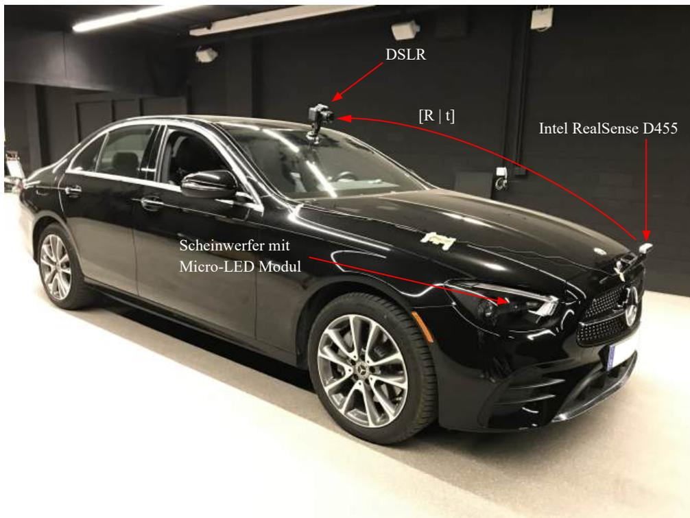
Abbildung 2.19.: Darstellung des eingesetzten Versuchsaufbaus
