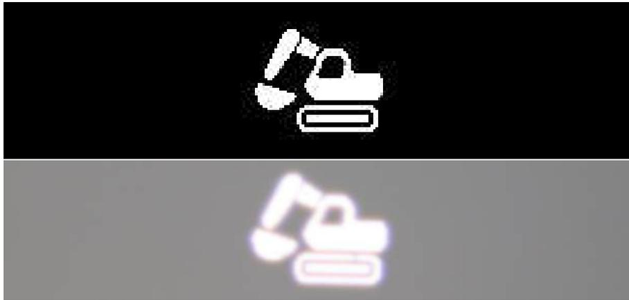
Abbildung 2.5.: Digitales Bild der Projektion und die tatsächliche Darstellung durch ein  $\mu$ LED-System auf einer weißen Wand
