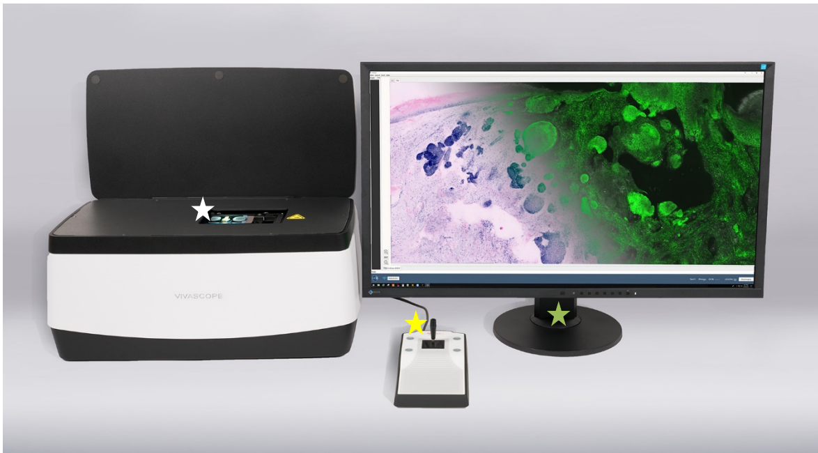
Abbildung 1: Vivascope2500M-G4. Links der eigentliche Scanner mit der Öffnung für das Einlegen des Objektträgers (weißer Stern). In der Mitte unten ist der Joystick zum Verschieben der Probe über dem Laser bzw. der Kamera (gelber Stern). Rechts der zum Laser dazugehörige Bildschirm (grüner Stern).
