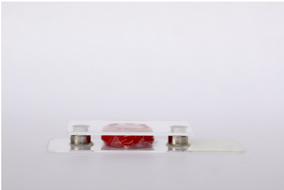
Abbildung 6: Platzierung der Knete zwischen Glasplatte und Objektträger.
