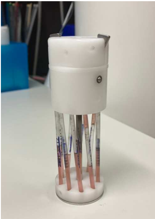
Abbildung 6: IceCube 11XS: Probenhalter für bis zu 10 Straws
