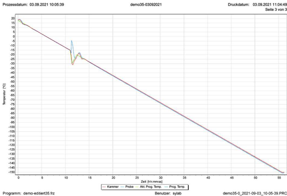
Abbildung 28: Einfrierkurve 21 zu Einfrierprogramm 21
