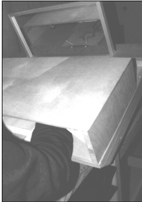
Abbildung 9: Mirror Drawing Task. Der Proband sieht den Stern, den er nachzeichnet nur im Spiegel. Die direkte Sicht auf die Zeichenfläche ist durch eine Abdeckung versperrt.
