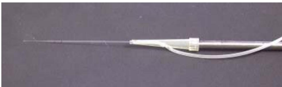
**Abbildung 6:** Einfassung der Glaskapillare
