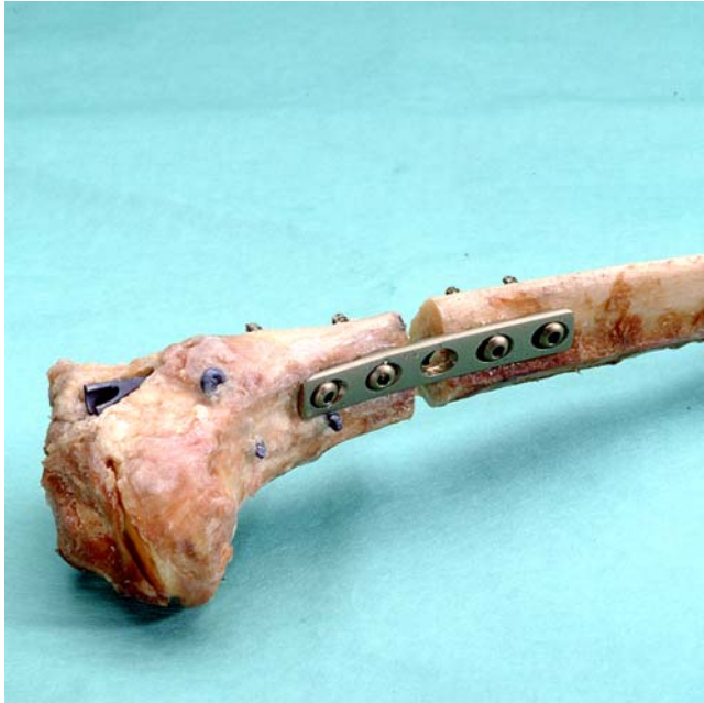
Abbildung 21: Versuchsknochen mit UTN und 5-Loch LC- DCP.
