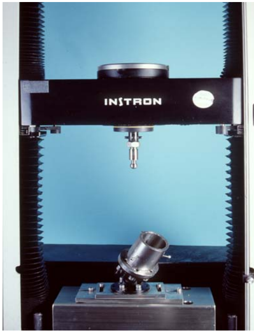
Abbildung 23: Instron Testmaschine mit distalem Fixationszylinder.
