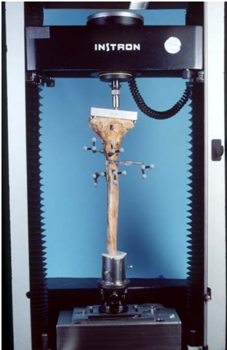
Abbildung 26: Versuchsaufbau, hier mit UTN und 5-Loch LC-DCP.
