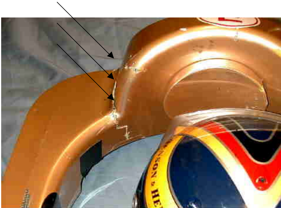
Abbildung 16: Beschädigung der Nackenstütze nach dem Unfall.
