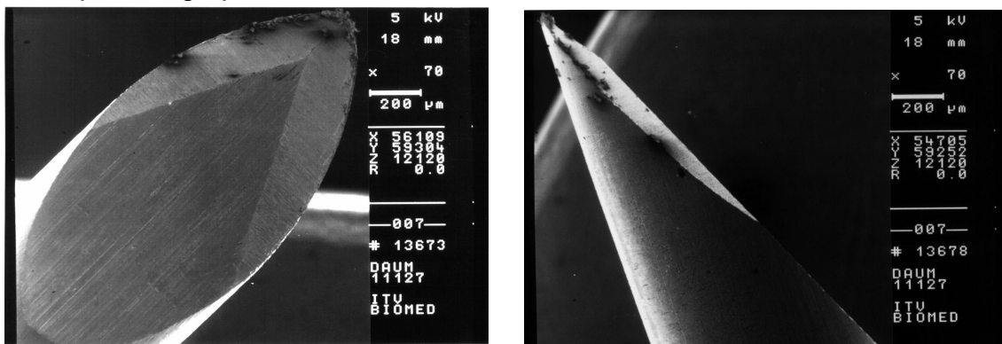
Abbildung 27/28: Biopsienadel 18G der Firma Daum in der REM-Aufnahme
