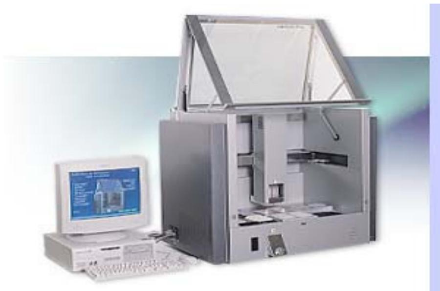
Der MagNA Pure LC™ Apparat (Roche Diagnostics, Penzberg) ist ein Nukleinsäureextraktionsautomat, der nach Einsatz der notwendigen
