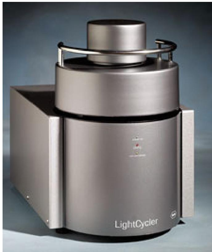
Die Glaskapillaren werden verschlossen und in das Probenkarussell des LightCycler™ Automaten eingesetzt. Um Luftblasen zu beseitigen und um den Reaktionsansatz in den unteren Teil der Kapillaren zu bringen, wird das Probenkarussell anschließend bei ca. 110 g zentrifugiert. Das Karussell wird
