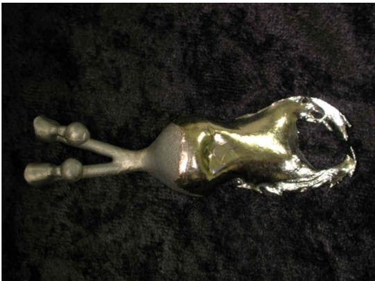
**Abb. 22** Ausgebettete und abgestrahlte Kronengerüste mit Gusskanälen und Gusskegel
