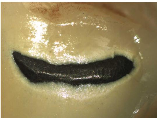
**Abb. 62** Lichtmikroskopische Aufnahme des Frakturbereiches am Brückenglied 14, Metalloxidschicht erkennbar
