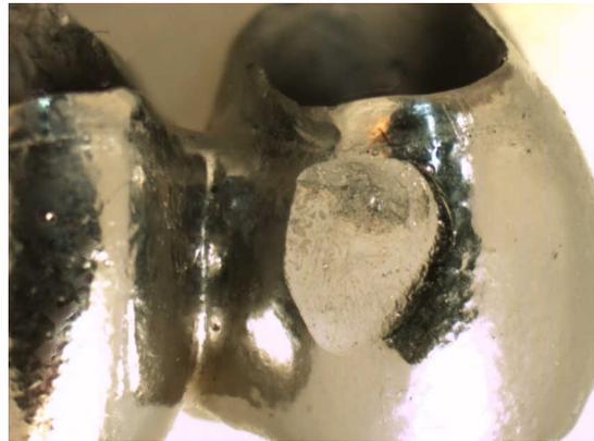
**Abb. 48** Lichtmikroskopische Aufnahme des Frakturbereiches an Krone 14 nach Gold-Palladium Besputterung
