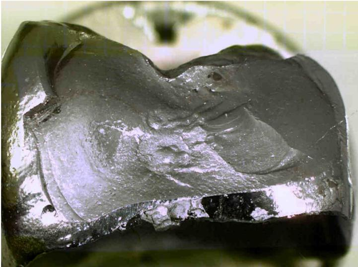
**Abb. 53** Lichtmikroskopische Aufnahme des Frakturbereiches an Krone 16 nach Gold-Palladium Besputterung
