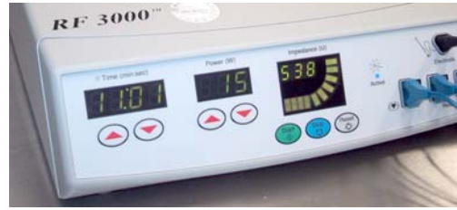
Abbildung 6: Impedanzanstieg (= „Roll off“) im Verlauf der Koagulation (rechtes Display) von 53 \Omega auf 538 \Omega .
