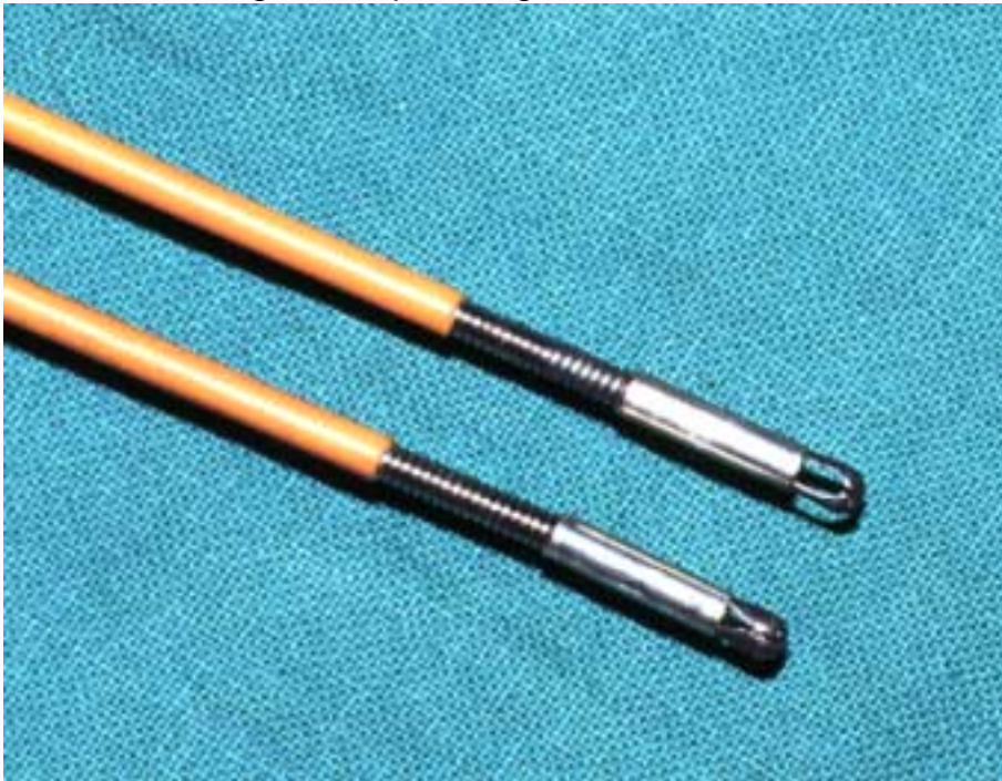
Abb. 95 Bearbeitetes Maulteil, der Freischliff ist in Form einer Aussparung zu erkennen.
