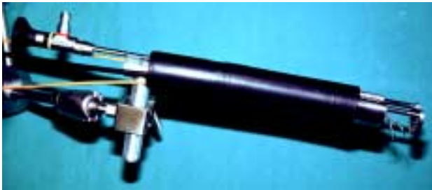
Abb. 114 Das Funktionsmodell wurde am Martinarm® befestigt, dieser auf dem Arbeitstisch fixiert. Faszangen und Optik waren im FM eingebracht.
