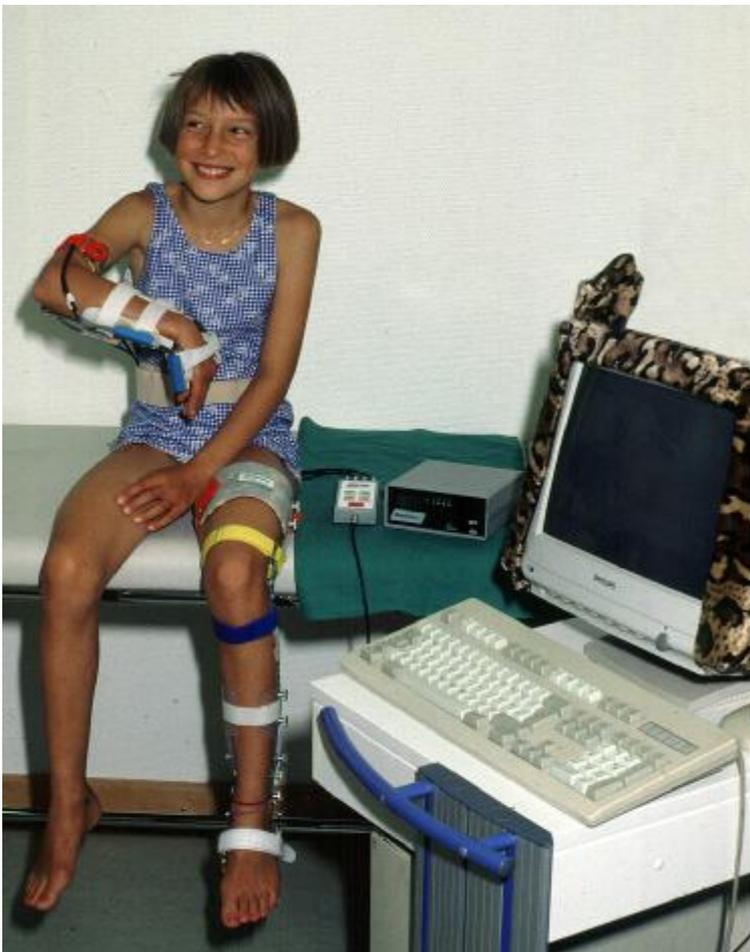
Abb. 41: Kind mit Schienen (hier sitzend wie zur Untersuchung des Sprunggelenkes), Elektrogoniometern und Meßeinrichtung
