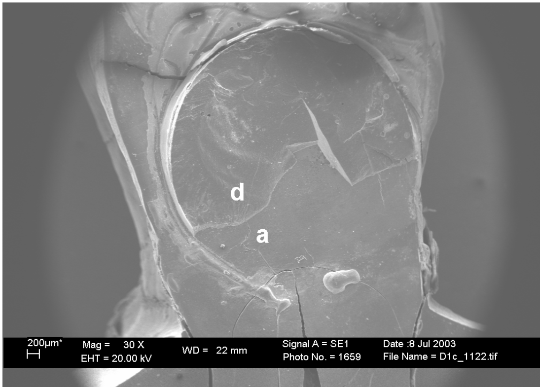
Abb. 16: Mikromorphologie der Dentinoberfläche nach dem Scherversuch bei 30-facher Vergrößerung (Gruppe D1c, Prüfkörper Nr. 11); a: Scherbruchfläche, d: zerbrochener Keramikzylinder.
