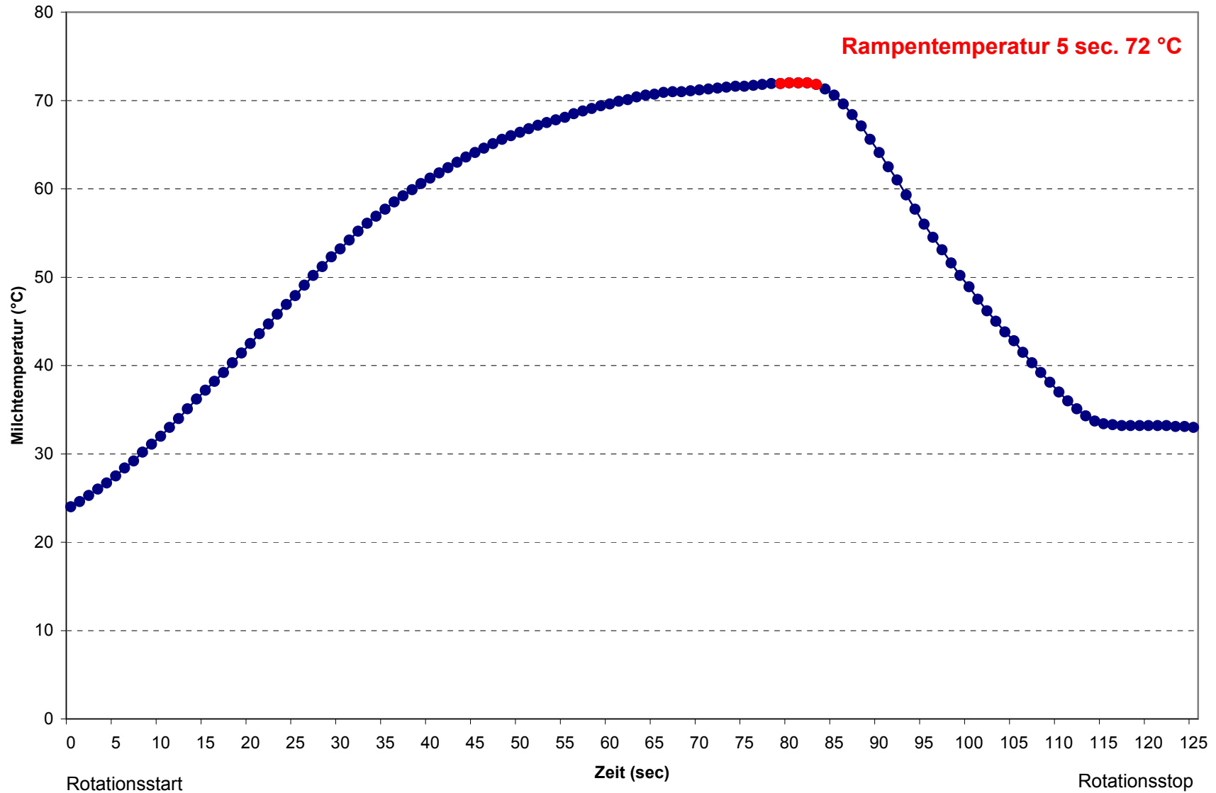
Abb. 9: Temperaturkurve des Milchfilms bei einer Inkubationsdauer von 5 Sekunden und einer Maximaltemperatur von 72 °C
