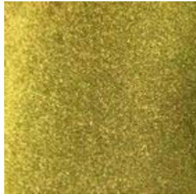
**Abbildung 59: Vector – Metallspitze, mit Abstand, Pulver grob + CoJet ( $R_a=0,37\mu\text{m}$ )**
