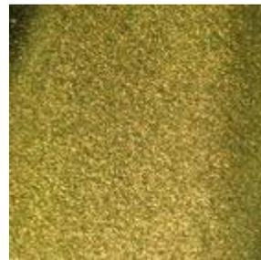
**Abbildung 37: Strahlen mit  $\text{Al}_2\text{O}_3$ -Sand bei steilem Aufprallwinkel ( $R_a=0,29\mu\text{m}$ )**
