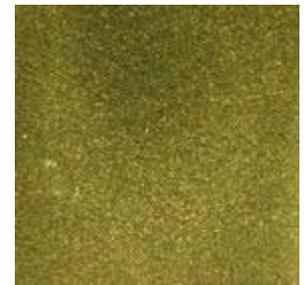
**Abbildung 38: Strahlen mit  $\text{Al}_2\text{O}_3$ -Sand bei flachem Aufprallwinkel ( $R_a=0,33\mu\text{m}$ )**
