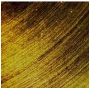
**Abbildung 35: Polierte Titanoberfläche ( $R_a=0,14\mu\text{m}$ )**
