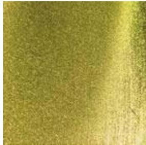
**Abbildung 55: Vector – Metallspitze, ohne Abstand, Pulver grob + CoJet ( $R_a=0,36\mu\text{m}$ )**
