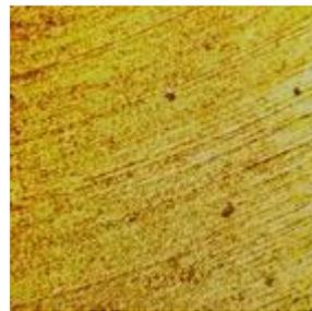
**Abbildung 48: Vector – Kunststoffspitze, mit Abstand, Pulver grob ( $R_a=0,26\mu\text{m}$ )**
