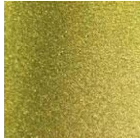
**Abbildung 56: Vector – Kunststoffspitze, mit Abstand, Pulver fein + CoJet ( $R_a=0,32\mu\text{m}$ )**
