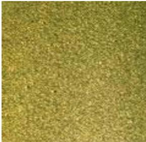
**Abbildung 54: Vector – Kunststoffspitze, ohne Abstand, Pulver grob + CoJet ( $R_a=0,33\mu\text{m}$ )**
