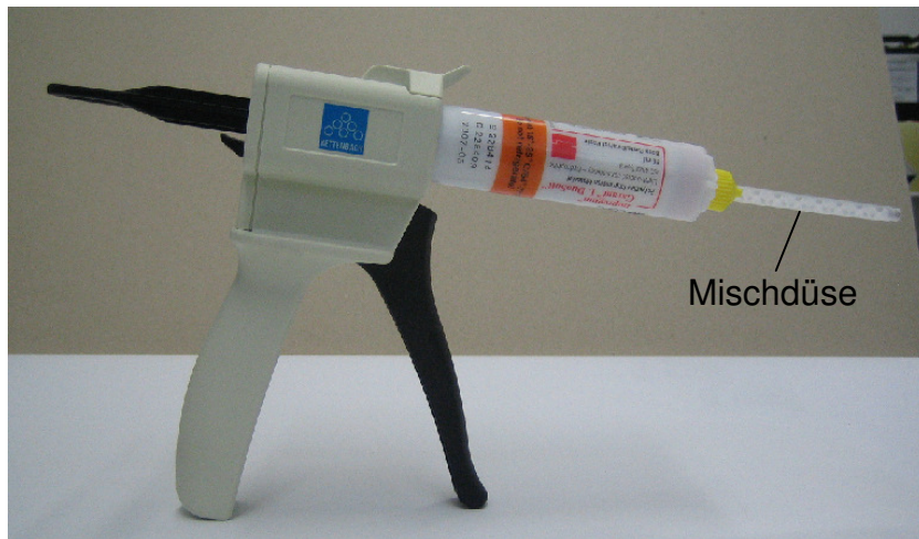
Abb. 9: Mischpistole mit Doppelkartusche und Mischdüse
