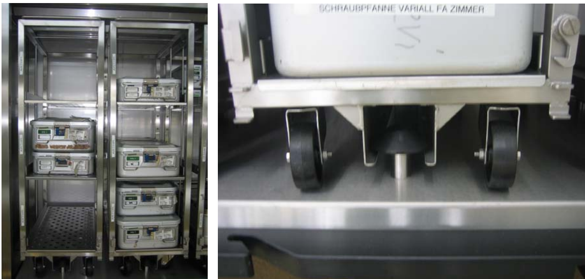
Abbildung 51: Die fahrbaren Wagen stehen auf 27cm hohen Podesten innerhalb der Regale.
