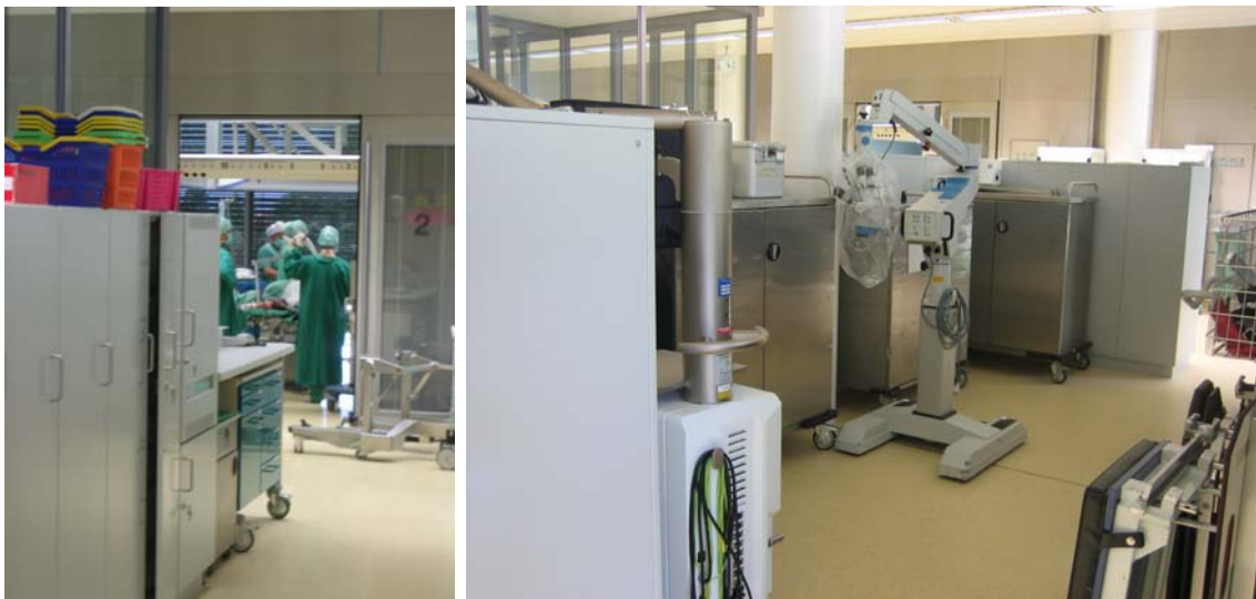
Abbildung 53: Zwischen den gegenüberliegenden Sälen sind 1,40m hohe Schränke aufgestellt, in deren Mitte die Geräte gelagert werden. Die Schränke sind deshalb nicht höher, damit der Blick in den gegenüberliegenden Saal möglich ist.
