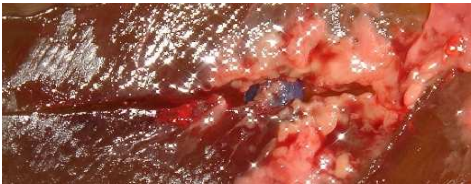
Abbildung 22 – Kügelchen eines PEP-Geschosses am Boden eines Gelatineblocks, an dem das Geschoss durch eine Spanplatte abgelenkt wurde
