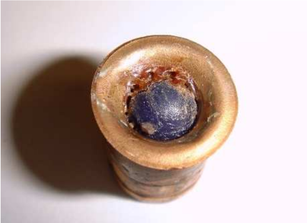
Abbildung 20 – Kugel mit makroskopisch sichtbaren Zellen nach Entfernung aus dem Gelatineblock im Labor
