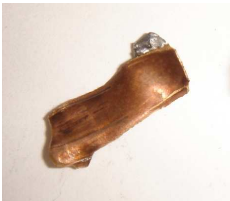
Abbildung 23 – Splitter eines HSG, welcher sich vom Geschoss löste
