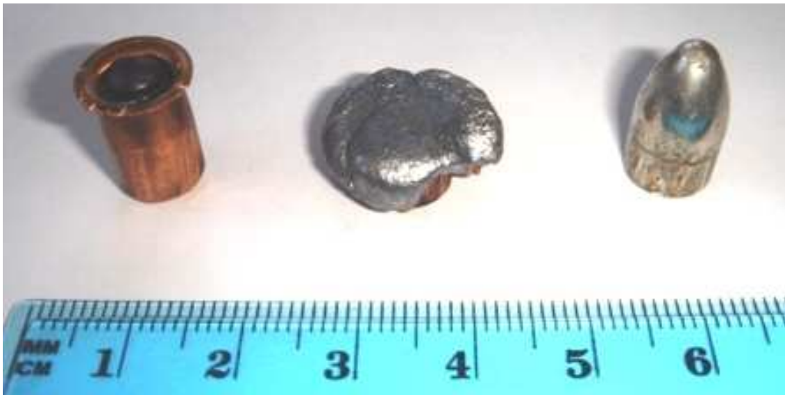
Abbildung 21 – Die verwendeten Geschosse nach Beschuss eines Gelatineblocks und Entfernung aus Selbigem (v.l. PEP, HSG, VMG)
