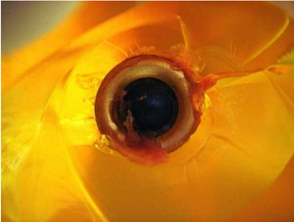
Abbildung 19 – Kugel mit makroskopisch sichtbaren biologischen Spuren im Gelatineblock
