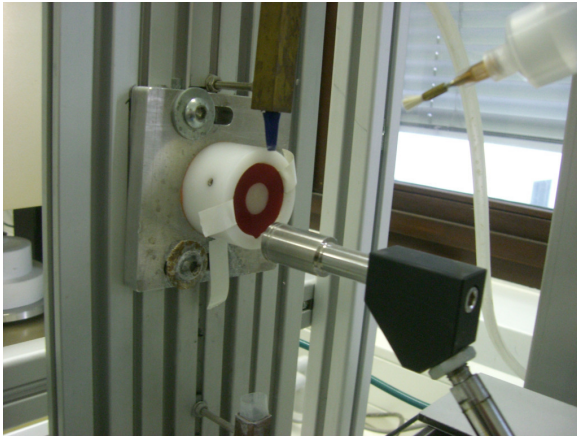
Abb. 6: (b) Originalbild der am Abrex angebrachten Teflonform sowie einer fixierten Kompositprobe (Abrex, 2-Medien-Abrasion )
