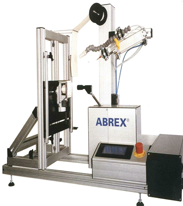
Abb. 5: In der Studie verwendete Abrex – Verschleißprüfvorrichtung
