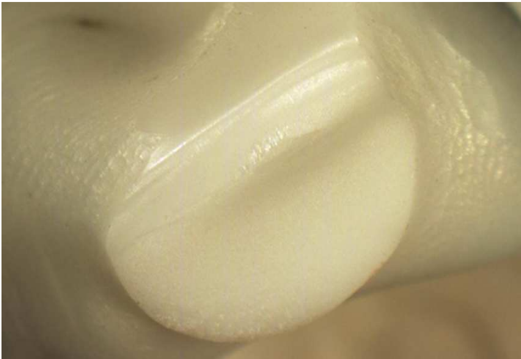
Abbildung 8: Mikroskopische Aufnahme einer Gerüstfraktur am Konnektor
