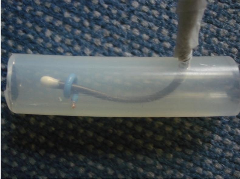
**Abbildung 8: Silikonschlauchstück mit eingebrachter Temperatursonde**
