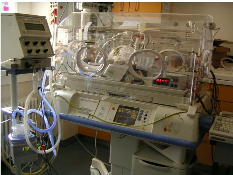
Abbildung 1: Der Messaufbau: Beatmungsgerät, Befeuchter (Messung mit dem MR 850), Inkubator, Lungenmodell
