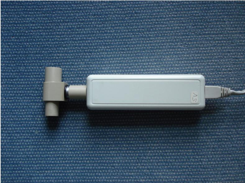
**Abbildung 7: Der Feuchtesensor FT202**
