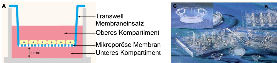
Abb. 4: Transwellsystem: (A) schematische Darstellung, (B) Fotografie der verschiedenen Transwellplatten, (C) einzelner Membraneinsatz (von [www.corning.com](http://www.corning.com)).
