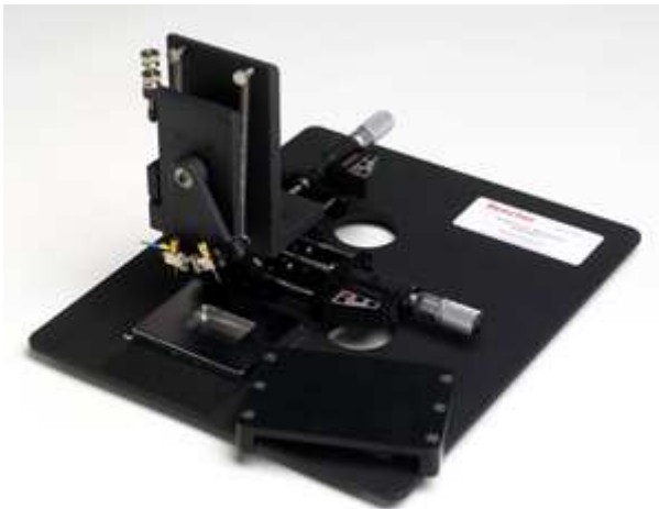
Abbildung 3: MTA-1 Manual Tissue Arrayer (Abbildung nach Beecher Instruments Inc., Sun Prairie, WI, USA).
