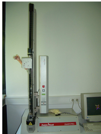
Abbildung 13: Materialtestungsmaschine UTS 3 (Zwick/Roell, Ulm, Deutschland) mit Präparat und angeschlossenem PC
