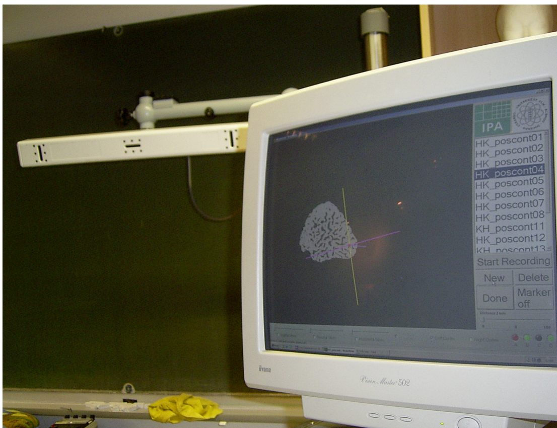
Abbildung 3: Kamera der optischen Positionierungsanlage und visuelle Darstellung. Auf dem Bildschirm dargestellt ist die linke Gehirnhälfte einer Versuchsperson mit Blick von dorsal. Die Linien symbolisieren die Spulenposition über dem Okzipitalpol, die gelbe Linie entspricht der Achse des Spulengriffes.
