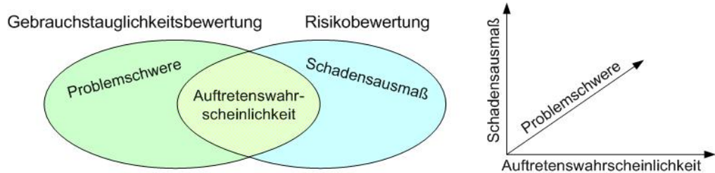
Abb. 84: Kombination der Gebrauchstauglichkeitsbewertung und der Risikobewertung für ein Konzept zur Bewertung der Gebrauchstauglichkeit medizinischer Produkte
