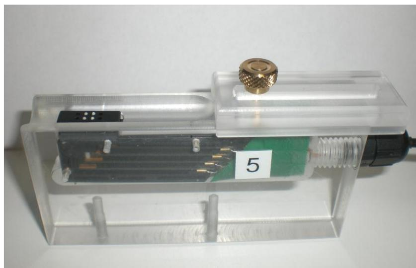
**Abbildung 10: Piezoelektrischer Stimulator zur Applikation der Störreize an der linken Hand**
