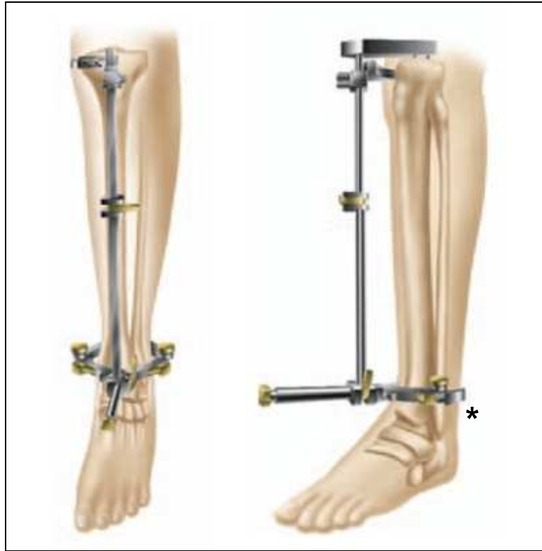
Abbildung 20: Darstellung der extramedullären Führungsschiene mit dem Bezugspunkt OSG (*)
