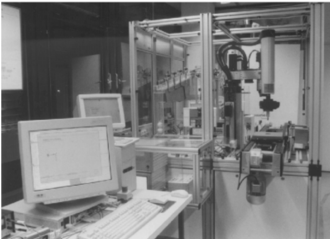
Abbildung A.1: Roboterzelle mit Steuerungsrechner
