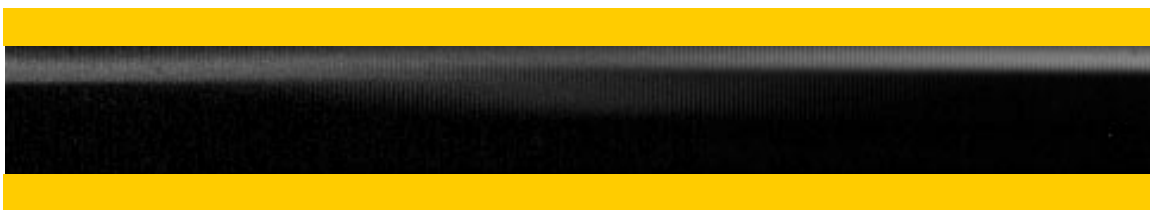
Bild 96: Photographie des Mikrokanals während des Experiments zur Herstellung dünner Analytschichten. Die Kanalwände sind der besseren Sichtbarkeit wegen hervorgehoben. Ansicht von oben.
