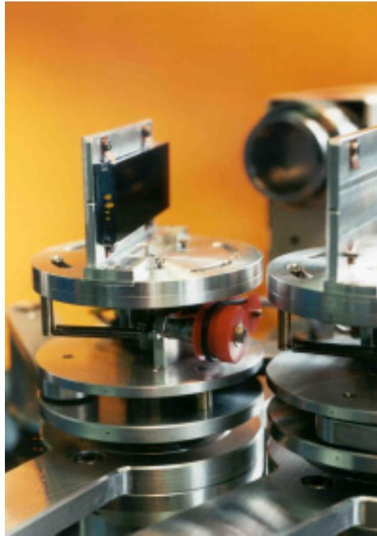
**Abb. 2.16** Analysatoreinheit mit montiertem Si-Analysatorkristall. Im Hintergrund ist der zugehörige Detektor zu sehen.
