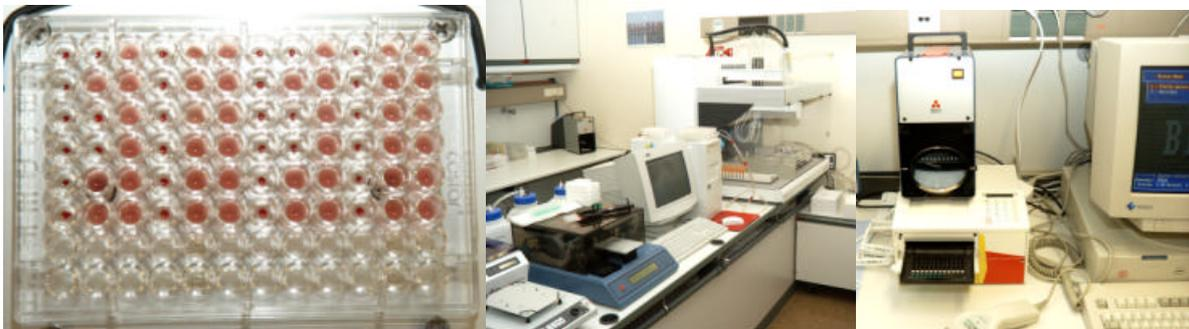
**Abb. 2.20:** Gefüllte Mikrotiterplatte (links), Pipettierautomat zur Befüllung der Platten (Mitte), automatischer optischer Ausleser der inkubierten Platten (rechts)
