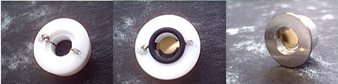
**Abb. 3.2: Quarzhalter aus Teflon ohne (links) und mit Quarz (incl. Viton-O-Ring, Mitte) sowie aus Metall (geklebt, rechts)**
