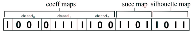
Abbildung 4.19: Erweiterung des Waveletstream zur Speicherung der Silhouetten-Information. Die Einträge des succ map und des silhouette map Bitfeldes ermöglichen die Bestimmung der Zugehörigkeit der Lichtfeldwerte zum Objekt.
