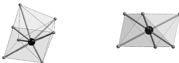
Abbildung 3.42: Koordinationspolyeder in Zr_7O_8N_4
