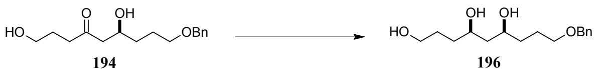
Abbildung 85: syn -Reduktion zum Triol 196 : i. Et 2 BOMe, NaBH 4 , THF/MeOH (4:1), -78°C, 3h; ii. MeOH, RT, 15 min, 5x, (93%)
