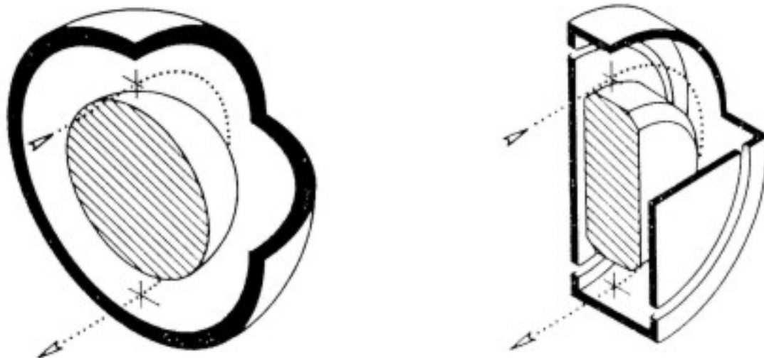
Abbildung 4.4: Vergleich der Geometrie eines sphärischen Spektrometers (links) mit dem Design des Jost'schen Spektrometers (rechts). Die gepunkteten Linien repräsentieren einen zu analysierenden Strahl. (Abbildung aus [26])
