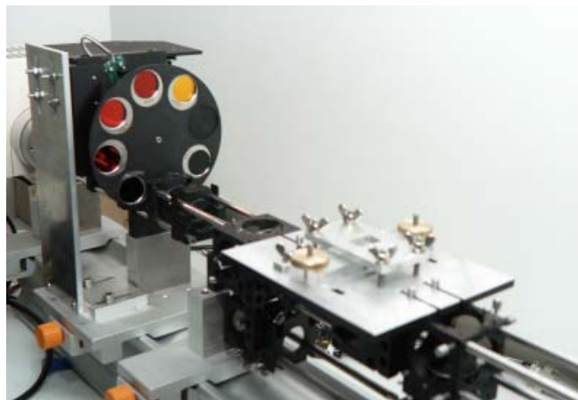
Abbildung 22 Man erkennt die auf das Prisma aufgebrachte und mit Rändelschrauben angepresste Probenaufnahme in Form einer rechteckigen Küvette. Die Prismenhalterung kann in dieser Konfiguration auch eine Durchflusszelle aufnehmen. Davon wurde in dieser Arbeit aber noch kein Gebrauch gemacht.
