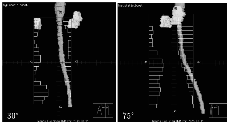
Abbildung 6.8: H&N–IMRT: MLC–Konfigurationen der jeweils größten Segmente zweier Bestrahlungsfelder. Die BEV deuten den bestrahlten Bereich an und veranschaulichen die Lage der planungsrelevanten OAR (Speicheldrüsen, Rückenmark).
